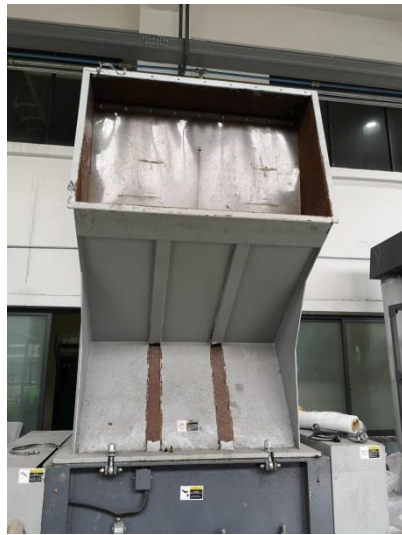
粉碎机加盖设施
