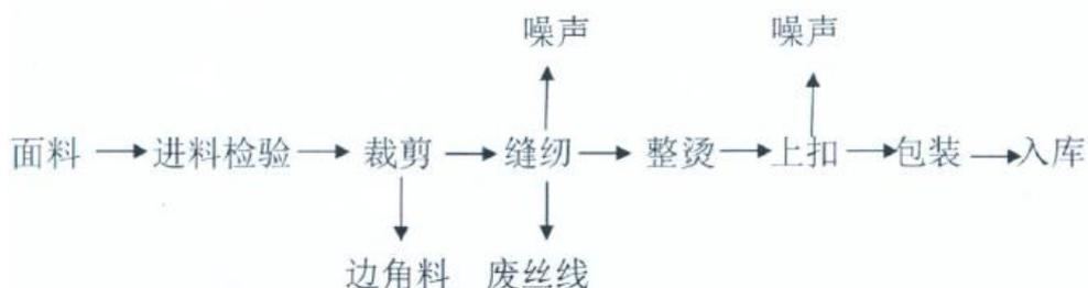
图 4.2-10 浩诚针织生产工艺流程图
