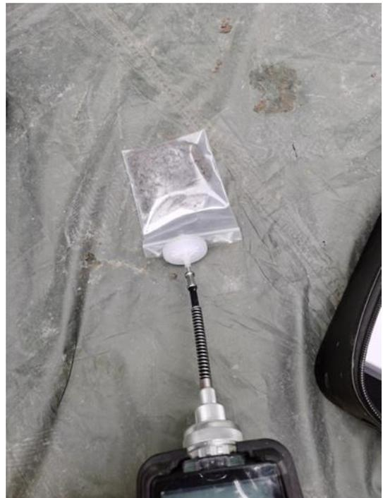
PID 快速监测照片
