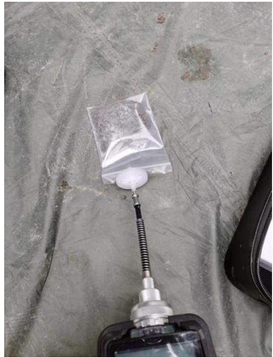
PID 快速监测照片
