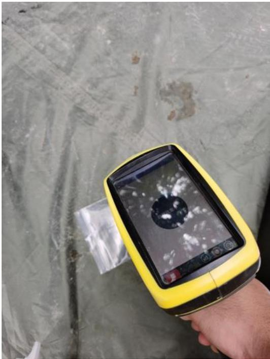
XRF 快速监测照片
