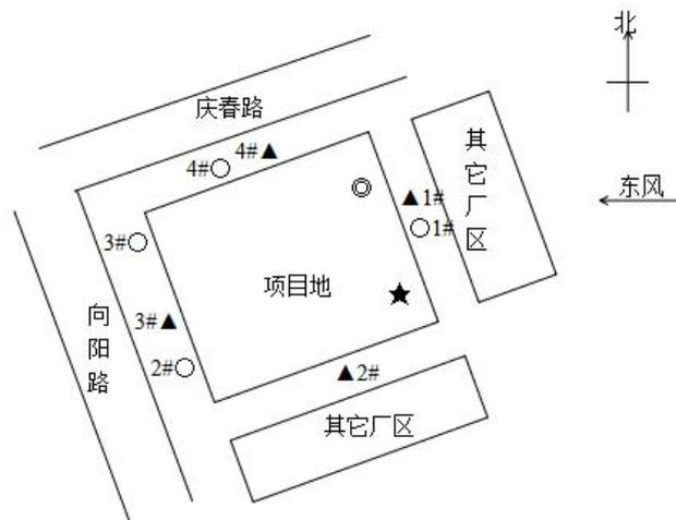
图 3-3 监测点位示意图（废水★、无组织废气○、有组织废气◎、噪声▲）
