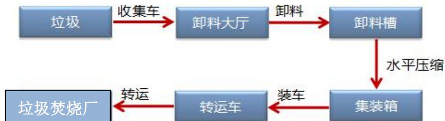
图 2-2 压缩工艺流程示意框图
