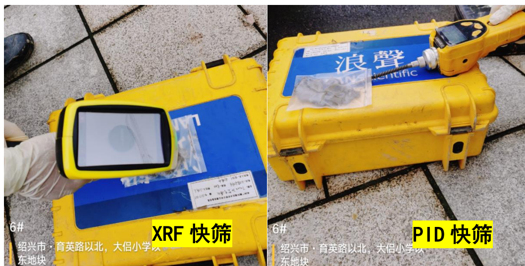
图 4.2-3 现场快速测定照片
