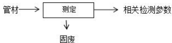
图 2-11 塑料管材环刚度、落锤冲击、维卡软化温度等检测流程及产污节点图
