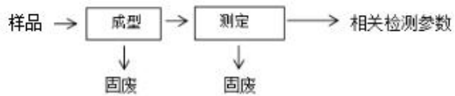
图 2-15 板材、幕墙、卷材物理性能检测流程及产污节点图
