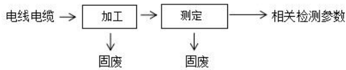
图 2-16 电线电缆电阻、绝缘电阻等检测流程及产污节点图
