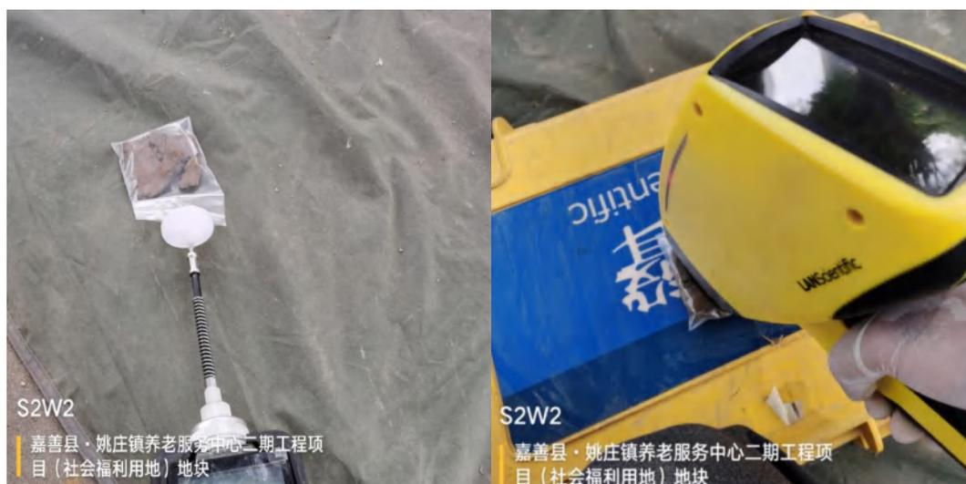
图 5.2.1.1-1 土壤快速检测设备 PID（左）和 XRF（右）
