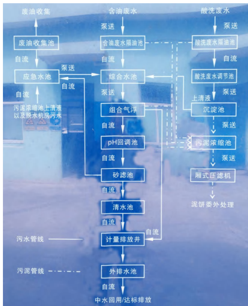
图 4.1-3 一园区生产废水处理工艺流程图
