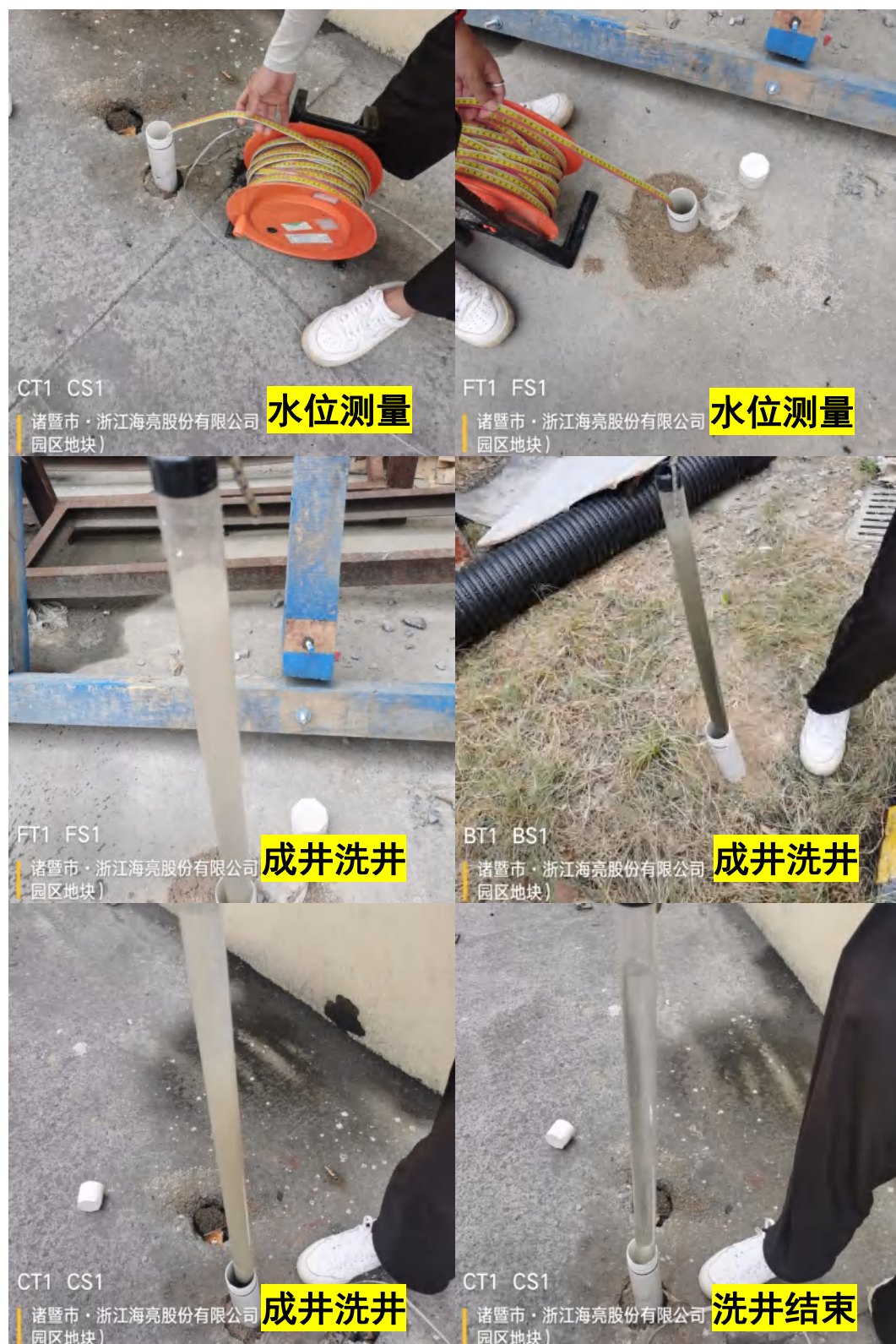
图 7.2-7 部分成井洗井照片
