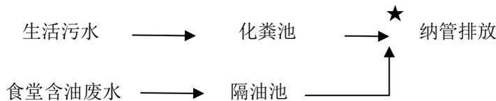
图 3-3 废水监测点位示意图（★为监测点位）
