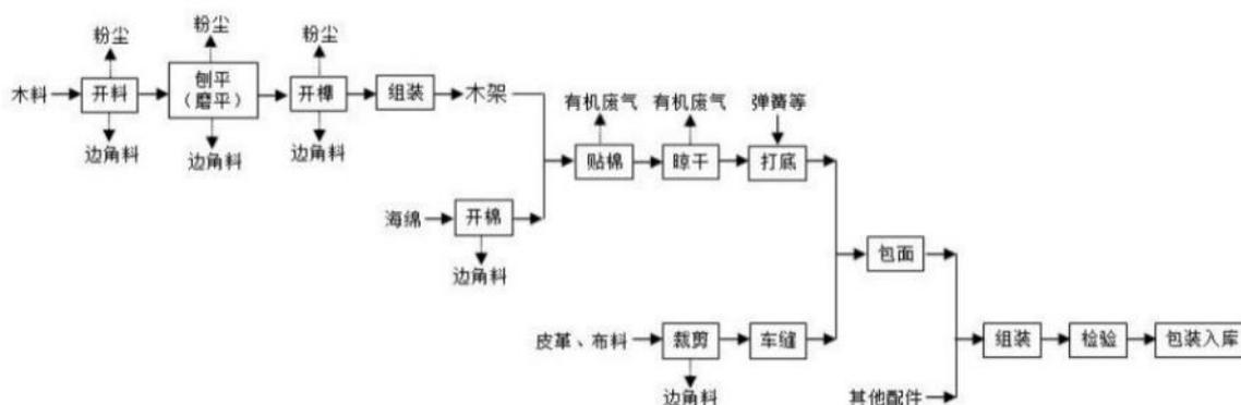
图 3.5-7 生产流程图
