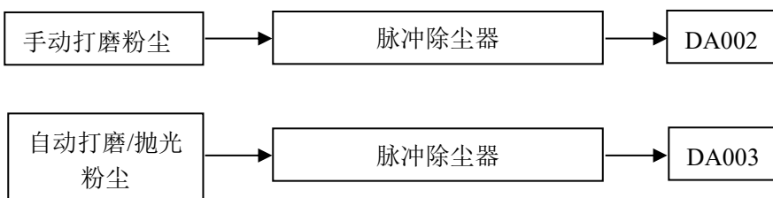
图 4-1 项目废气处理工艺流程图
