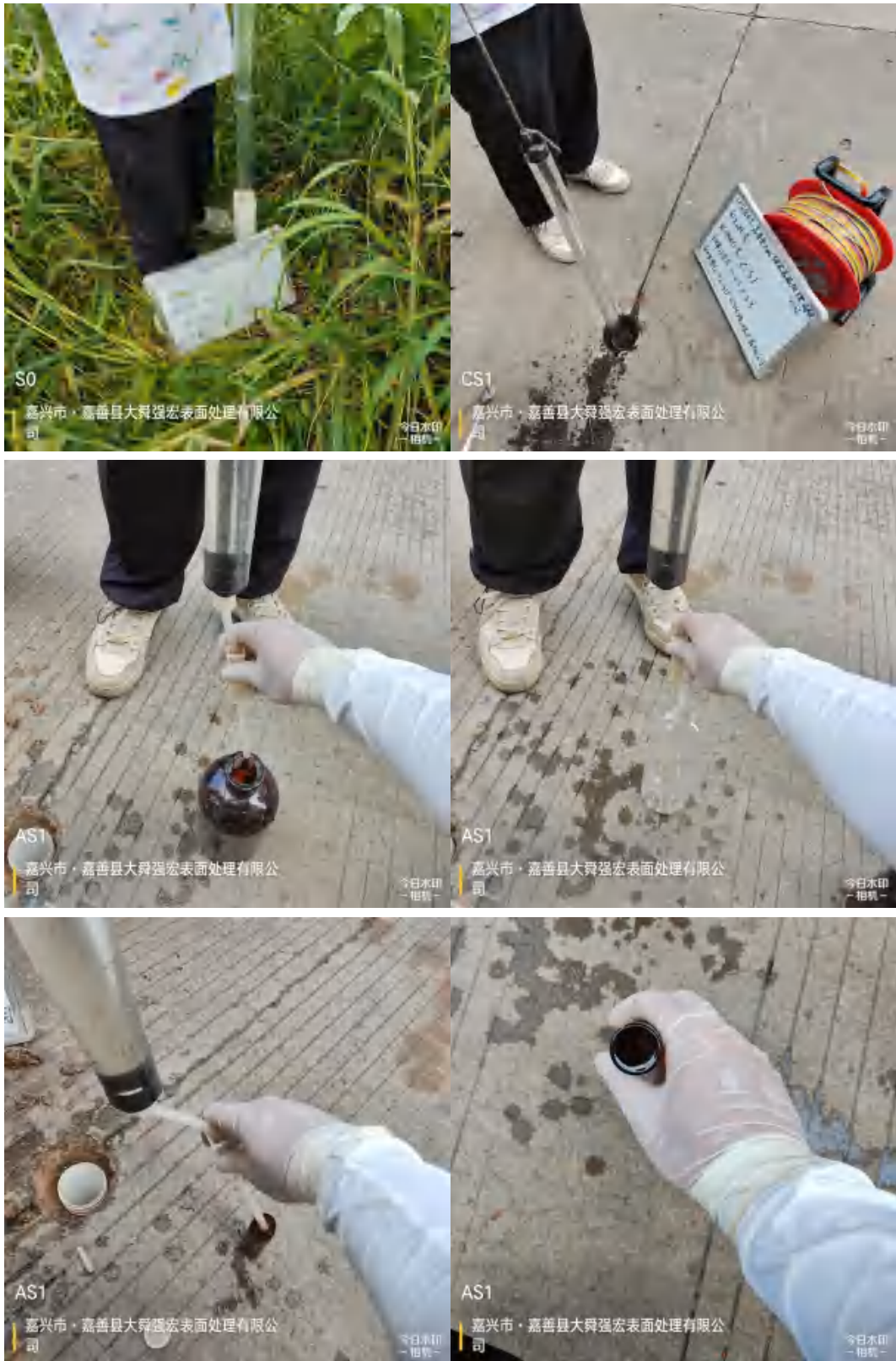
图 7.2-3 部分地下水洗井及采样照片
