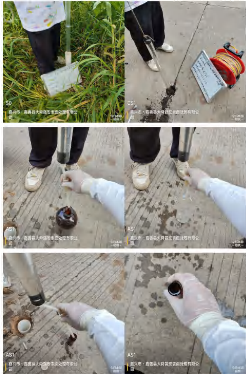
图 4 部分地下水洗井及采样照片
