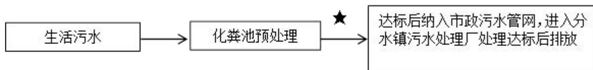
图 3-1 废水处理流程图及监测点位示意图（★为监测点位）
