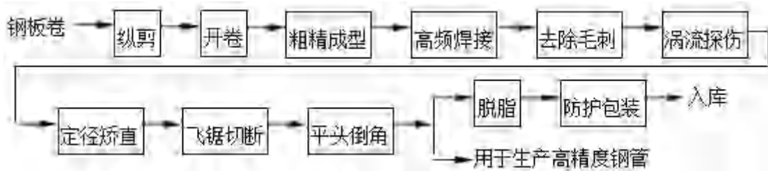
图 4.1-1 精密焊管生产工艺
