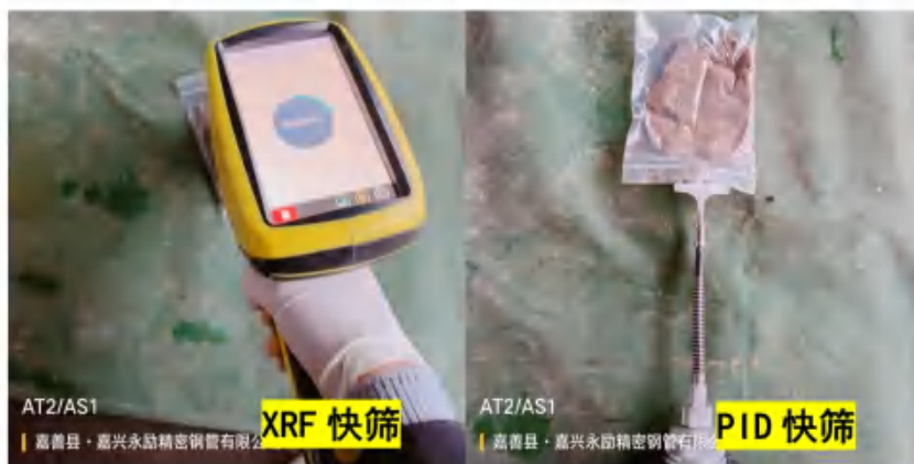
现场快速检测土壤中 VOCs 时,用采样铲在 VOCs 取样相同位置采集土壤置于聚乙烯自封袋中,自封袋中土壤样品体积占 1/2~2/3 自封袋体积。取样后,自封袋置于背光处进行快速检测。检测时,将土样尽量揉碎,振荡自封袋约 30s,静置 2min 后将 PID 探头放入自封袋顶空 1/2 处,紧闭自封袋,记录最高读数,填写至《土壤快速筛选记录单》。
